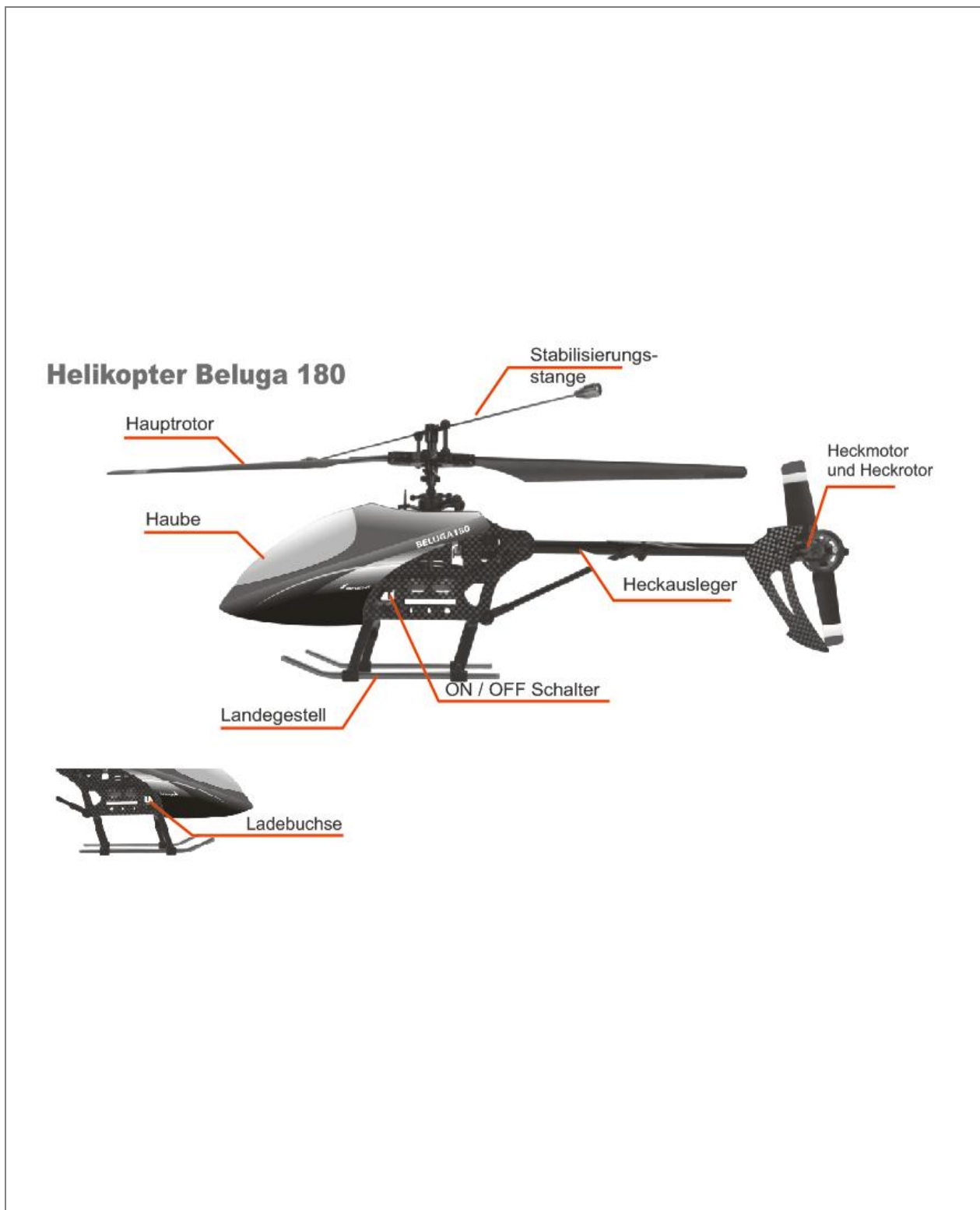
Bild 1: Komponenten des Hubschraubers
